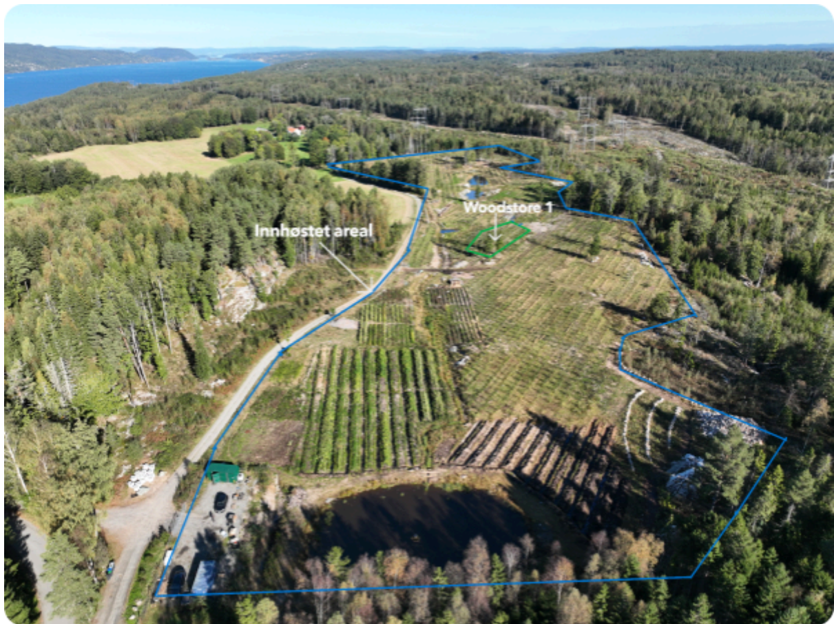
Figur 8: To år etter etableringen av Woodstore Pilot 1. Det blå innrammede området viser innhøstingsfeltet, mens den grønne innrammingen markerer overflaten av karbonkammeret og synliggjør hvor lite areal metoden beslaglegger.
